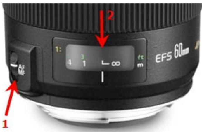
*En macro, vous devez passer en mise au point manuelle MF (1) afin de régler le grossissement désiré (2), et ensuite vous approcher du sujet afin de le placer dans la zone de netteté (Objectif Canon macro USM EF-S 60mm).*
